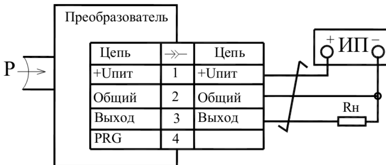
Рисунок В.1 — Схема подключения преобразователей общепромышленного исполнения с разъемами исполнений 10,13, 60 по таблице А.10
